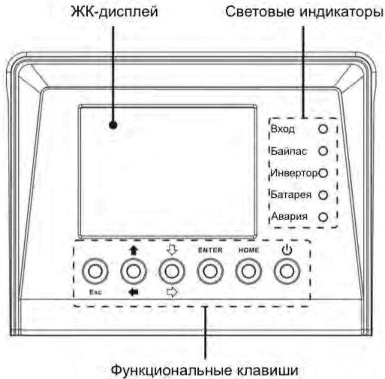
Рисунок 5.5.3 Внешний вид панели управления
