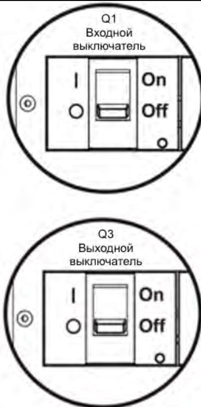
Отключите входной выключатель (Q1) и выходной выключатель (Q2), как показано на рисунке.
